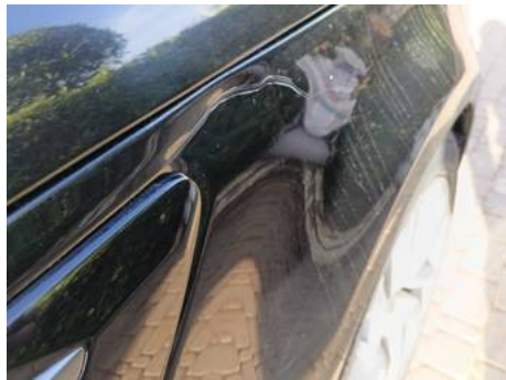
Aile avant droite (Impact)
